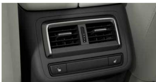
Las salidas de la ventilación con persianas en la parte posterior de la gran consola central frontal proporcionan un flujo de aire ajustable independientemente a los pasajeros en la parte posterior del vehículo. Los asientos izquierdo y derecho posteriores están climatizados con un control de temperatura de tres fases.
